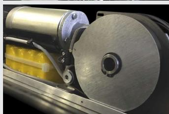
Batterie a bordo contenute nell'ingombro standard dell'automazione.
